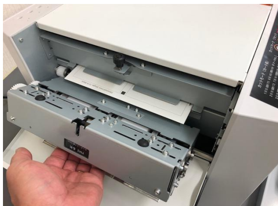
スリッターユニット取り外し
