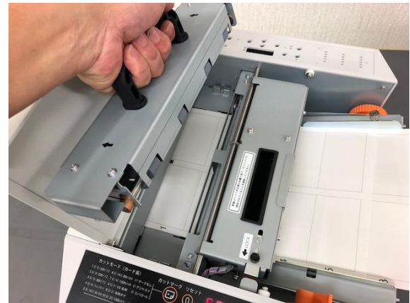
加圧ユニット取り外し
