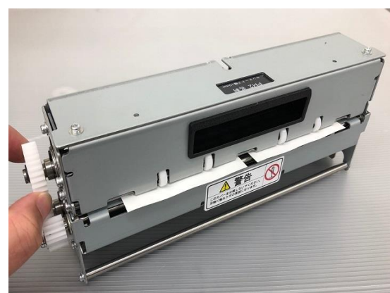
スリッターユニットの紙除去
